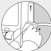
5. 포충기 전선케이블을 가로등 내부로 삽입해 연결
