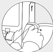
5. 포충기 전선케이블을 가로등 내부로 삽입해 연결
